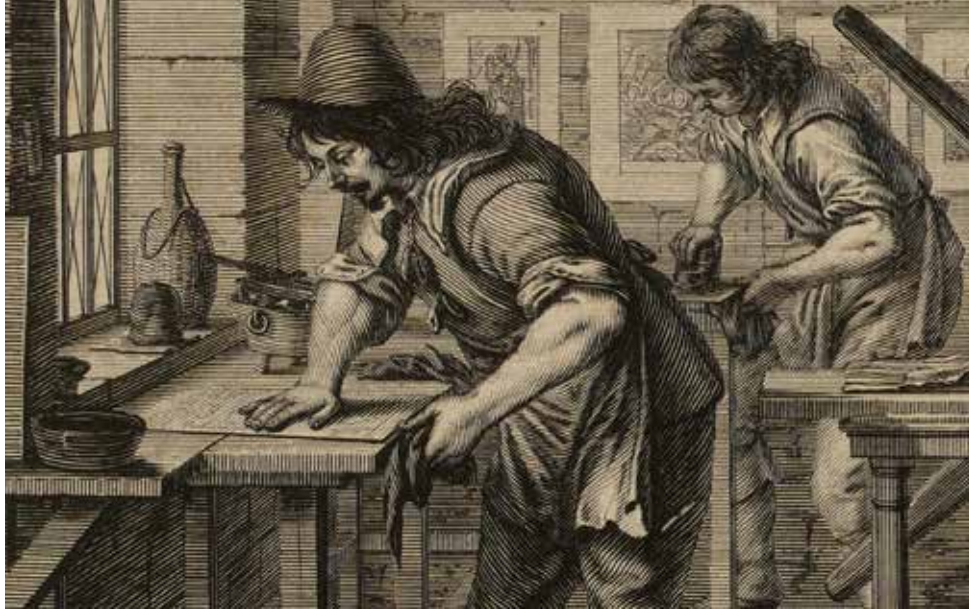
Sur cette illustration d'Abraham Bosse, on voit au fond un homme qui encrè la plaque avec un tampon, et au premier plan autre qui parfait l'essuyage en frottant la plaque au Blanc de Meudon avec sa main. © BnF
